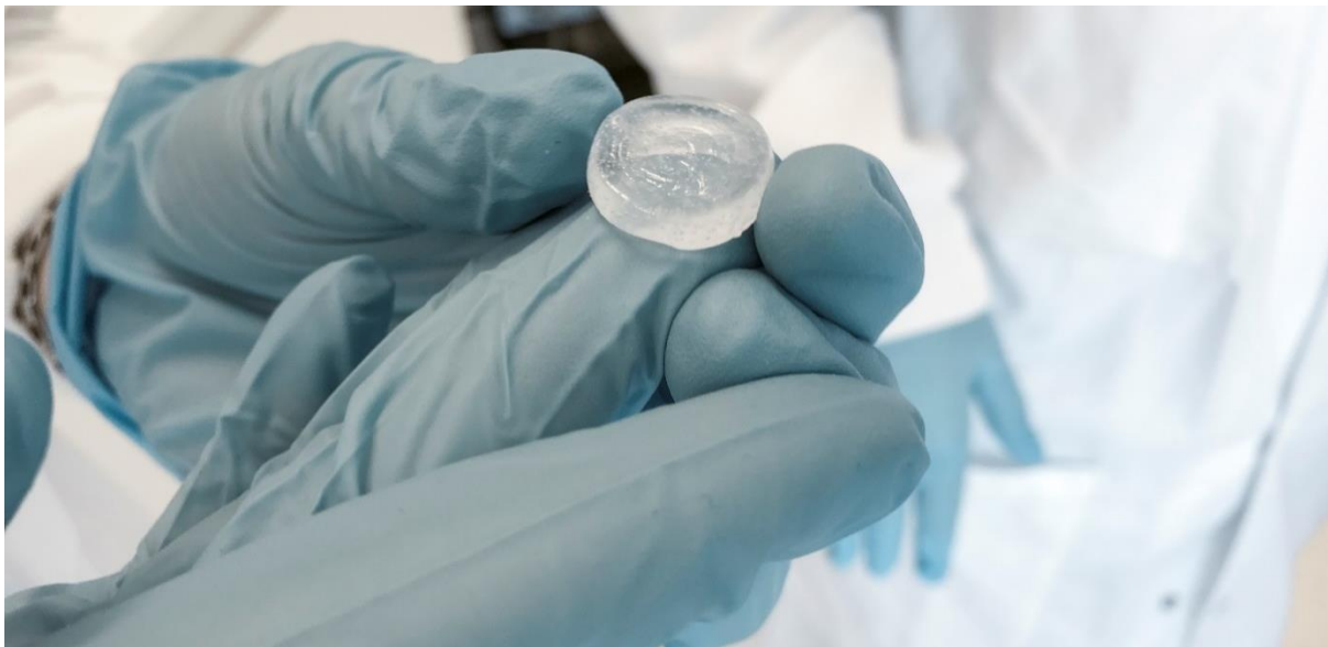
Figur 16 - Av de testade materialen var kMFC 5M bäst med avseende på fukt- och formhållning.
