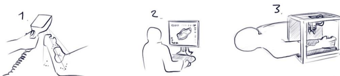
Figur 6 - Konceptidé; Genom att scanna såret kan en CAD-fil genereras och sedan kan ett förband anpassat efter sårets konturer printas i 3D.
