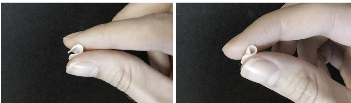
Figur 5 - Tvärbunden eMFCa som torkats i rumstemperatur blev flexibel och kunde böjas utan att gå av.
