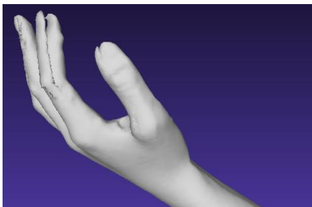
Figur 39. Scan av en hand där två modeller av pekfingeret har blivit sammanfogade, men inte överlappar helt korrekt.
